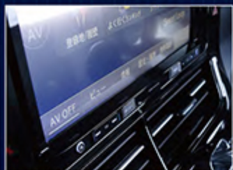
カロッツェリア「楽ナビ」のハードキーには凹凸が付けられていて、運転中も触感での操作が可能だ。使いやすさへの配慮が行き届いている。
