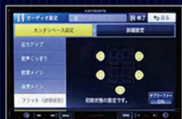
クルマの中には音響に不利な条件が多々ある。カロッツェリアの「楽ナビ」は、写真の「かんたんベース設定」等の音質調整機能も搭載し、それらに対処することが可能だ。
